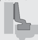
вкладная навеска (База В -3 мм)
