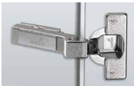
Угловые петли Intermat W30 ▶ Для угла корпуса 30° ▶ Угол открывания 95°
