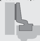
вкладная навеска (База В -3,5 мм)
